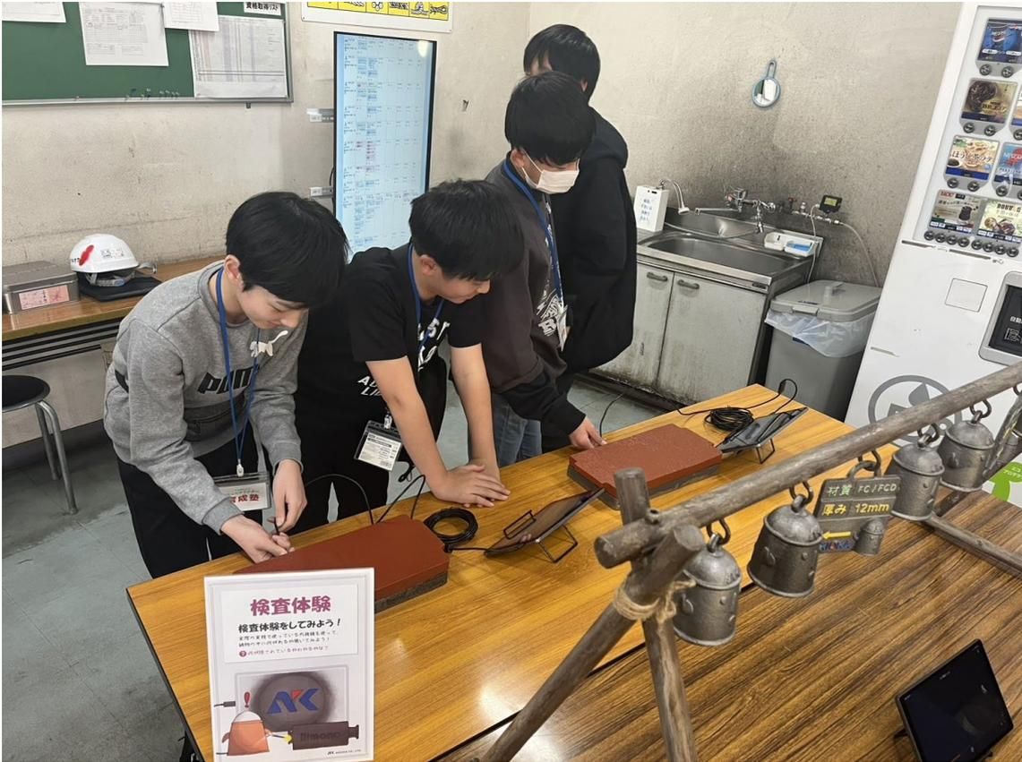
打音検査では、材料や金属の厚みによる音の違いを体感し、音によって鋳物の品質を確認するプロセスを学びました。特に、アキオカの鋳造技術課が考案した「ハニ造」を使用した体験は、大きな反響を呼びました。
